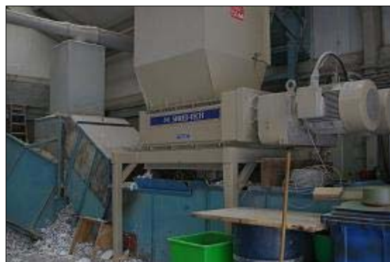
↓ 【コンベア併設の破砕機】
